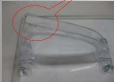
【取っ手の衝撃テスト】 衝撃による変形痕
